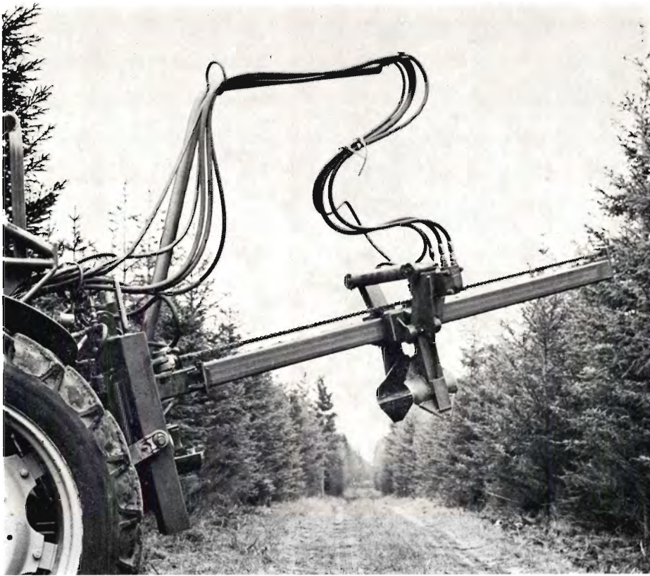
Fig. 1. Afkvistningsmaskinen SKRAP har en 3 meter lang bane, hvorpå det bevægelige afkvistningshoved kører frem og tilbage.
