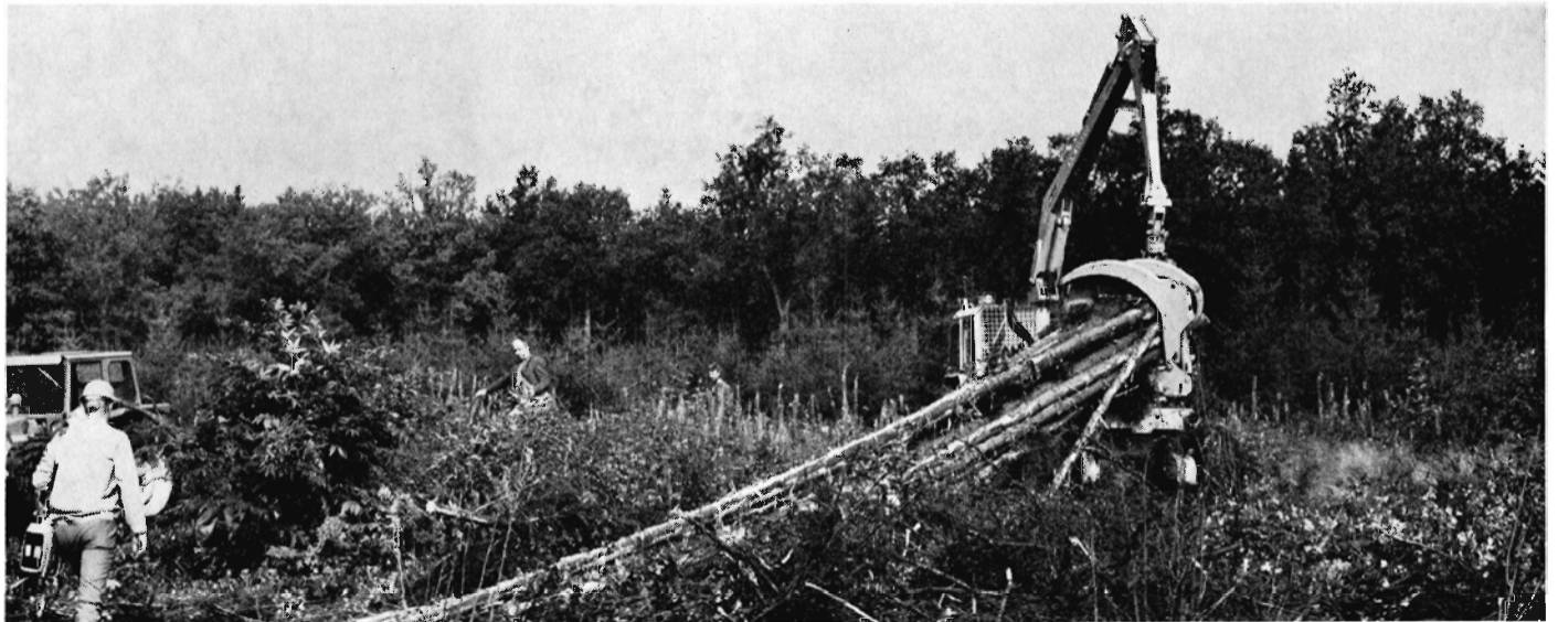
Udslæbning af de afviste stammer til bilvej. Det sker med en BM-Volvo 868 med klembanke.
