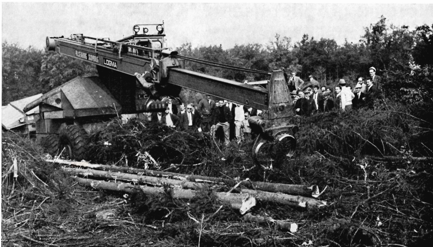
Frijsenborg Skovbrugs Logma kvister træer i fuld længde. Dens kapacitet er 60-80 træer i timen.
