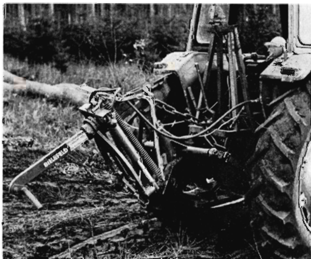
KUXMANN II. Hydraulisk udslæbnings-saks, som helt betjenes fra førersædet. Ved udslæbning af 3 m træ tages 1 m ad gangen.
