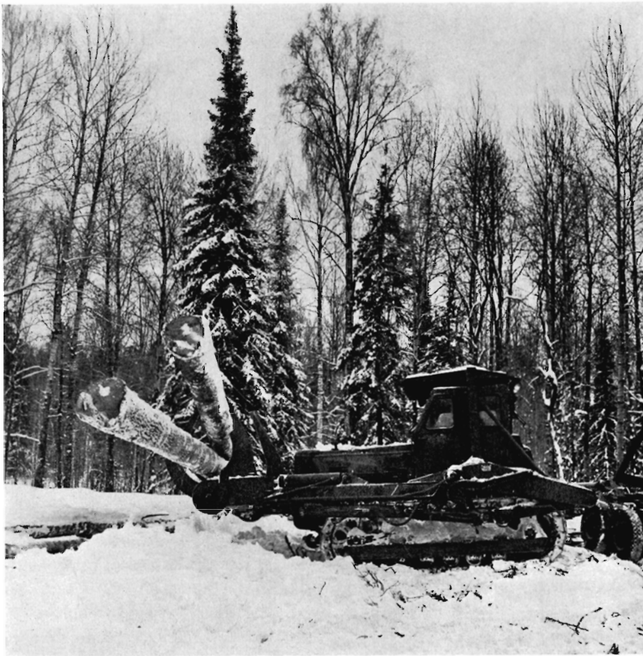
Hydraulisk traktor løfter stammerne og fører dem hen til transportvognen.
