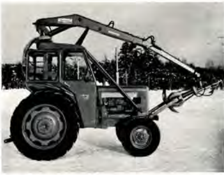
Fig. 6. Stammemetode og sortimentsmetode. Vindel Björn type SK 2000. Løfteevne 400 kg på 4 m arm. Pris ca. 14.700 kr. Leverandør Rosenberg & Wiboltt.
