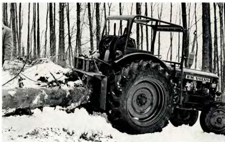
Fig. 5. Egnet materiel til stammemetode og til almindelig udslæbning. Totromlet Iglan Special spil. Trækkraft 4 tons, beskyttelsesskjoldet sidder i liften og kan hæves og sænkes. Prisen er ca. 10.000 kroner. Forhandler: DLAM:s forskellige afdelinger. Herudover bør nævnes, at også det velkendte Indslev spil er meget egnet, navnlig ved transport af stort træ.
