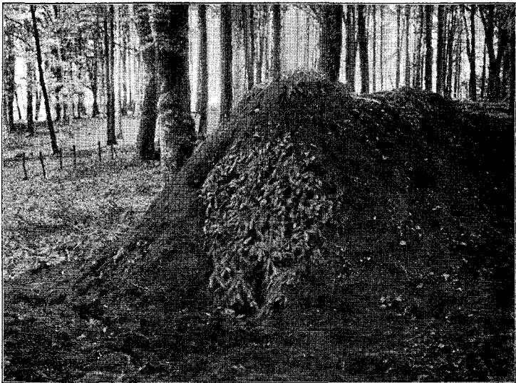
Fig. 10. Uden paa Granrisene lægges et Lag Kulster, dog ikke paa Milens Top.
