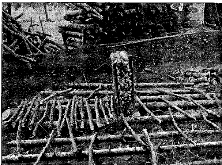
Fig. 4. Den første Begyndelse til en Mile. Paa Jorden Bundlægter; i Midten Hjertet; til venstre Antændings-Kanalen. Le premier commencement d'une meule. Sur le sol, des lattes de fond; au milieu, le cœur; à gauche, le canal d'allumage.
