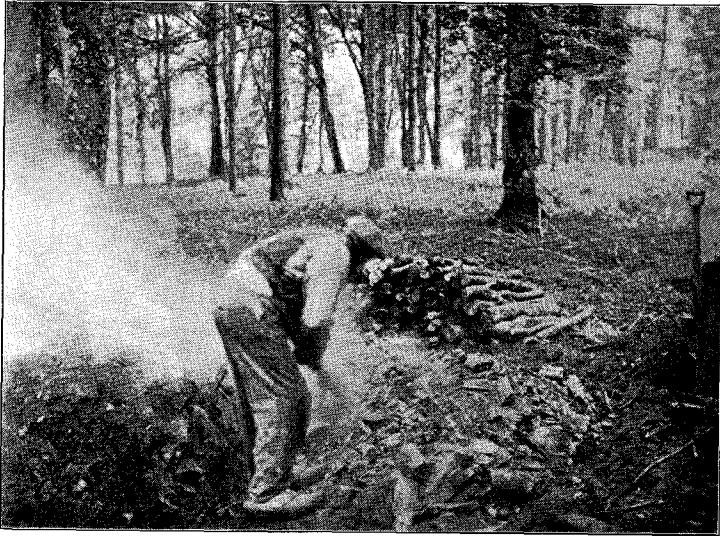
Fig. 21. Kullene rives sammen. Les charbons sont amassés avec le râteau.
