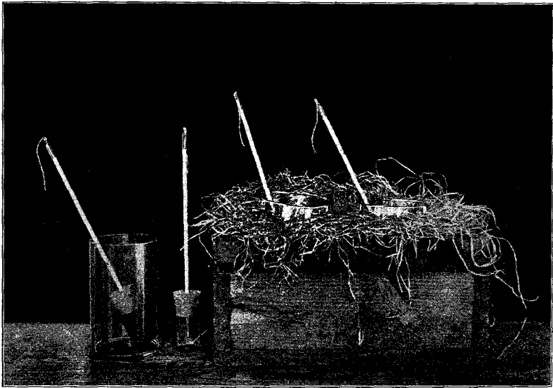
Fig. 6. Apparat til Forsøg med Frysning af Agern og Bog. Til venstre ses det store Glaskar, som indeholder Kuldeblandingen af Vand, Salt og Is; og inden i dette ses det mindre Glas — med Gummiprop og Termometer —, hvori Agern og Bog anbringes enten i Luft eller i Jord. Til højre ses Frysekarrene ompakket med varmeisolerende Træuld.
