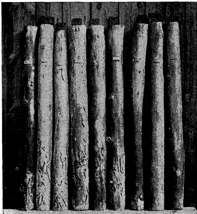
Fig. 10. Pæle udsat med paasiddende Bark \frac{0}{6} 35, optaget \frac{11}{9} 36. Fra venstre: Rødgran, Nordmannsgran, Grandis, Sitkagran, Douglasiæ, Europæisk Lærk, Japansk Lærk, Ask, Bøg.
