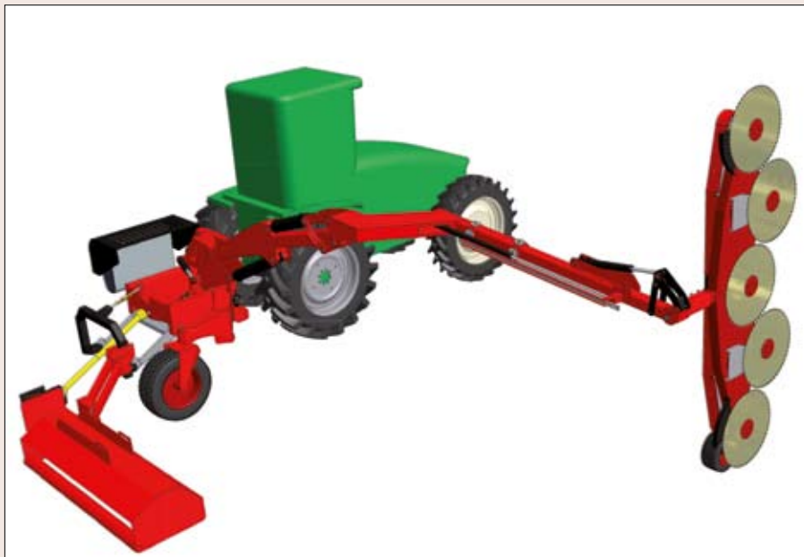
Figur 6. EM Elkær, type HK-Max er en hegnsklipper som kan afskære og knuse de afskårne grene i én arbejdsgang.
