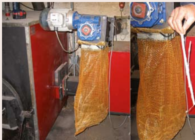
Figur 3. Overdahl Uddosering med Fjedersystem er en siloudmader til flis med automatisk frasortering af stikkere mv.
