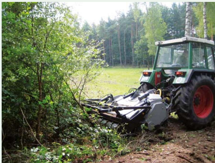
FAE SSL Speed er en kombination af en grenknuser og en rodfræser. Den er velegnet til mindre plantager.
