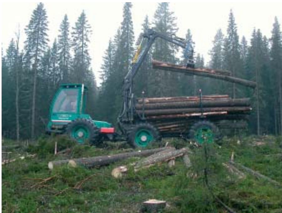
Udkørselsmaskinen med 6 elmotorer kan halvere energiforbruget. Foto: Roger Gustavsson, Thordab AB.
