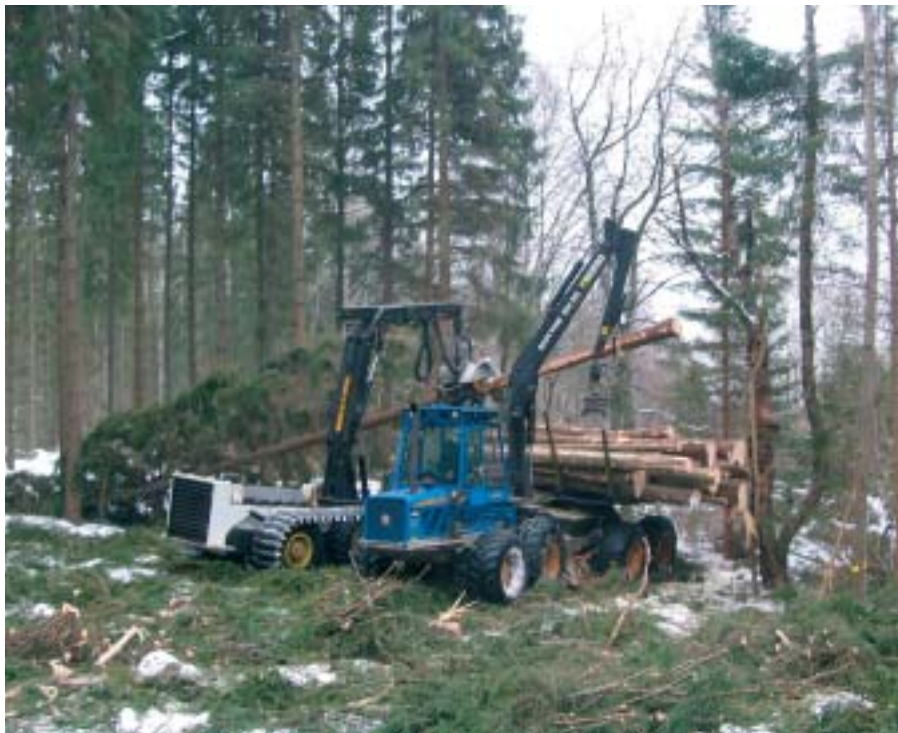
Den førerløse skovningsmaskine Besten (bagest) lægger stokkene direkte op i lastrummet. Foto: Skogforsk.
