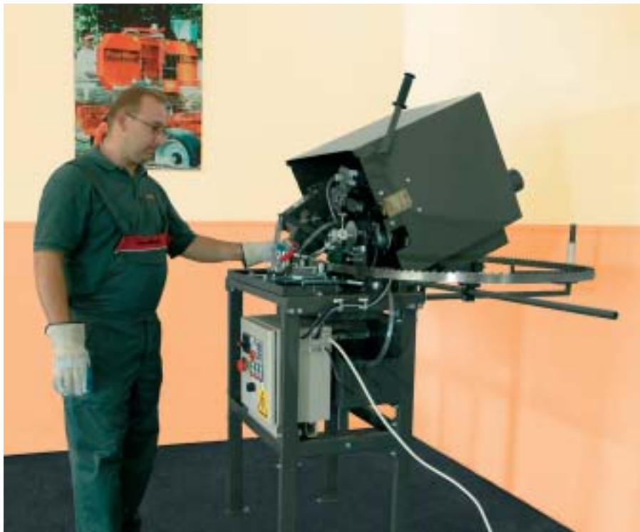
Skærping af båndsavklinge til mobilsav.
