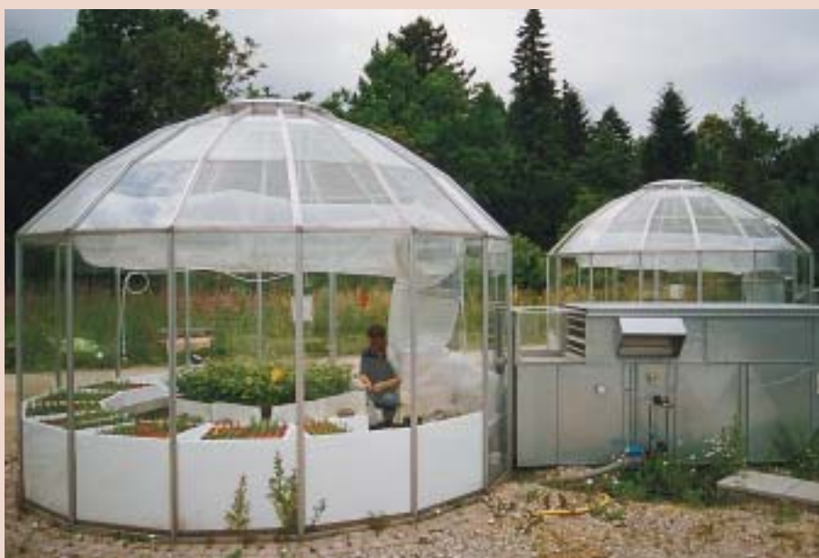
Figur 1. Otte klimastyrede glashuse (CTC) på Landbohøjskolens Arboret blev i vækstsæsonen 1998 anvendt til eksponering af to bøge- og to granprovenien- ser. Temperaturen blev styret til niveauer både over og under omgivelsernes, og [CO 2 ] blev øget i halvdelen af husene – se tabel 1. Andre klimaforhold, som fx luftfugtighed afveg kun lidt fra omgivelsernes.
