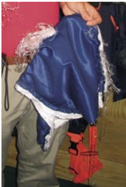
Figur 1. Forestshield har fremstillet nyt skæreindlæg til motorsavsbrug. Indlægget har kun 4 lag, men er syet i "sløjfer" således at der frigives en stor mængde skærehæmmende tråde ved snit i bukserne. Herved kan indlægget reduceres, bukserne er ikke så varme, og de er væsentlig mere fleksible over knæet.
