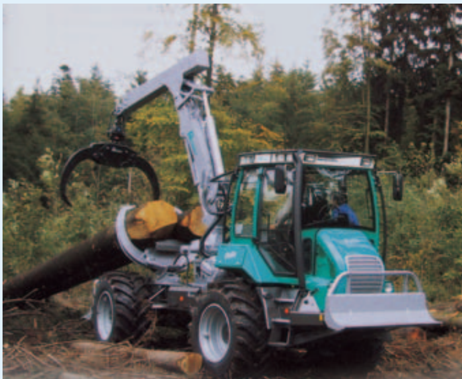
Felix basismaskine i version K som er egnet til langtømmer.
