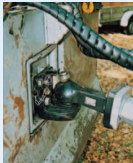
Kuglekoblingen på PM 2390 betyder at man ikke får stød hver gang man ændrer retning. Koblingen kan vendes indad ved udsælbnning.
