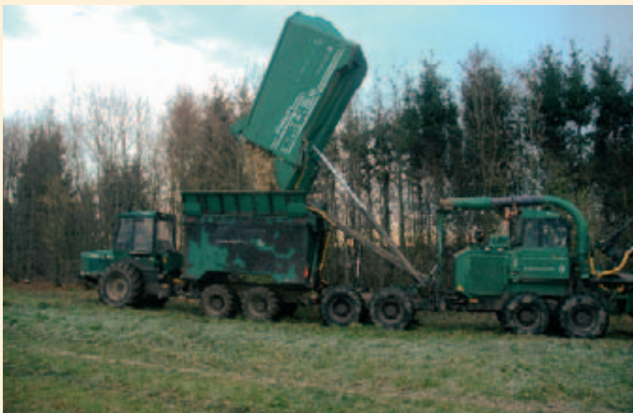
Foto 3. Når tanken er fuld læsses flisen over i en transportvogn som kører ud til fast vej. (Det er svært at se hvad der sker i en tæt bevoksning, og derfor er foto 2 og 3 optaget uden for).
