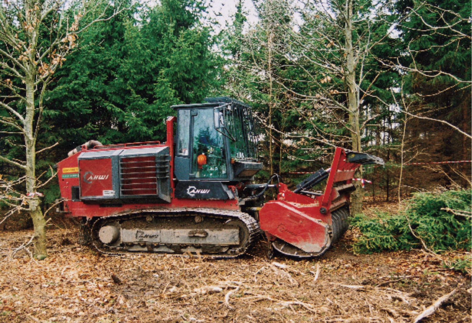
Foto 1. Grenknusning med Ahwi knuseren. Mindre træer og buske lægges ned af maskinen før de knuses.
