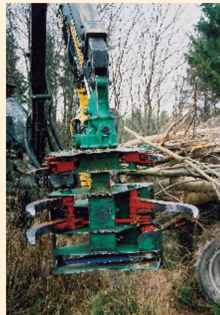
Foto 5. Træer fældes med et fældeaggregat som kan akkumulere 2-3 træer på én gang.
