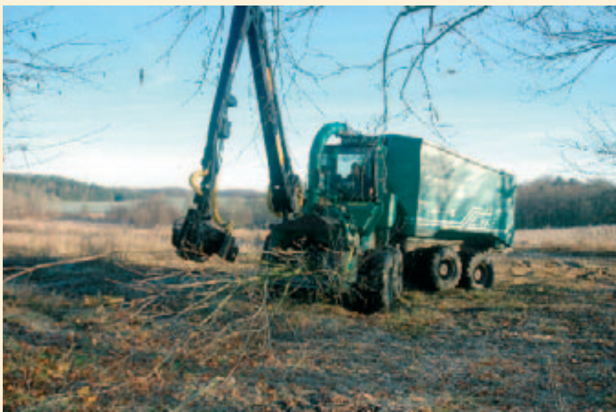
Foto 2. Den bestandsgående flishugger mader træerne ind forfra; flisen blæses op i tanken der rummer 15 rm.
