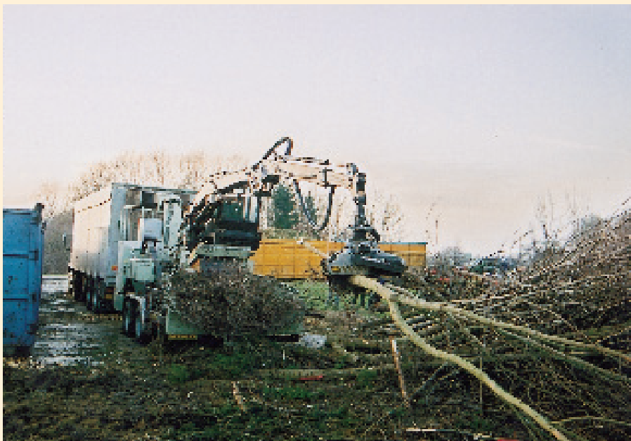
Foto 6. Heltræer flises af flishugger direkte op i lastbilen.
