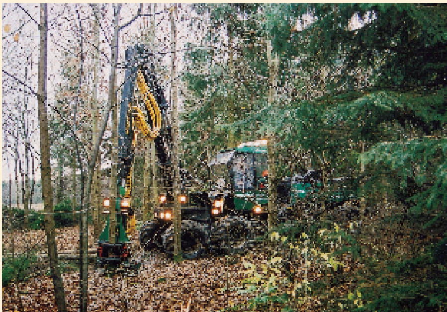
Foto 4. Fældebunkelægger som lægger træerne ned på sporet.
