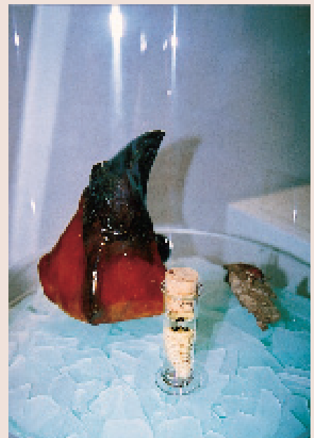
Motorsavens tænder er inspireret af den amerikanske træbuk. Fotoet til højre viser tanden i stor udgave, og foran ses larven der er 10 cm lang.
