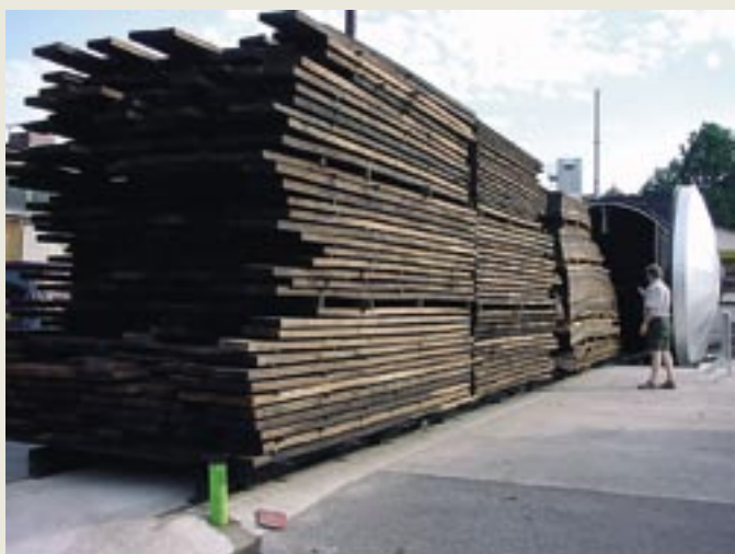
Egeplanker efter ammoniakbehandling – det ligner nu tropisk træ.
