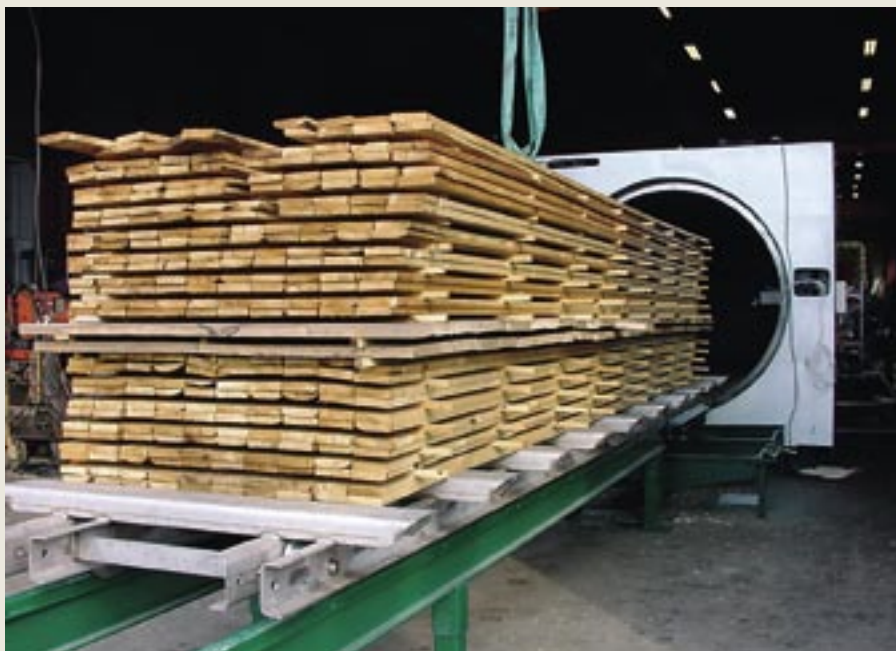
Ask sendes til varmebehandling for at blive mørkfarvet.
