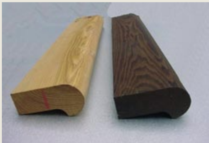
Gelænder i ask – til venstre ubehandlet, til højre varmebehandlet.
