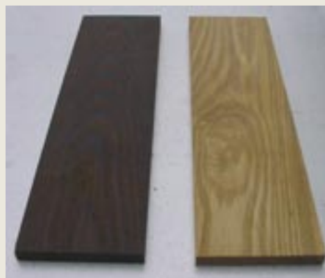
Øverst. varmebehandlet ask (som har fået olie efterfølgende), nederst ubehandlet.
