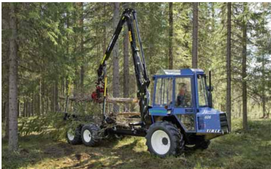
Foto 1. Vimek BioCombi håndterer på én gang skovning, lastning og udkørsel.
