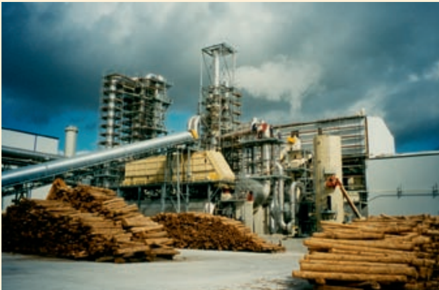
Markedet for træplader ventes fortsat at stige i 2008 trods stigende konkurrence med energitræ. (Foto af Kronospans fabrik for OSB plader i Luxembourg; OSB = Oriented Strand Board, laves af lange brede høvlspåner og konkurrerer især med krydsfiner).
