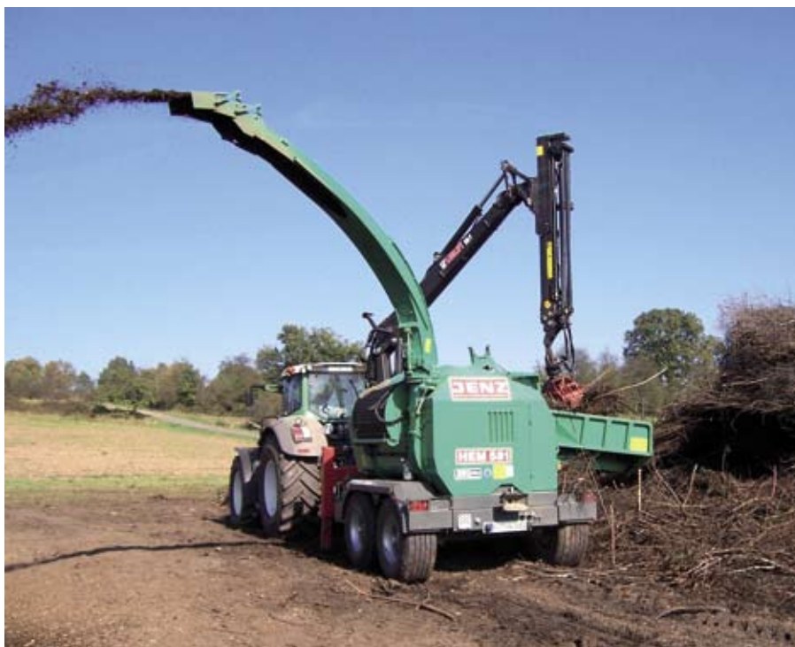
Jenz HEM 581 Z kan arbejde ved skovvej eller andre steder hvor en lastbil kan afhente den producerede flis.
