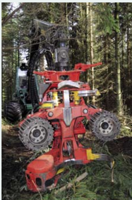
SP 561 LF aggregatet med ekstra griberne lige over selve aggregatet.
