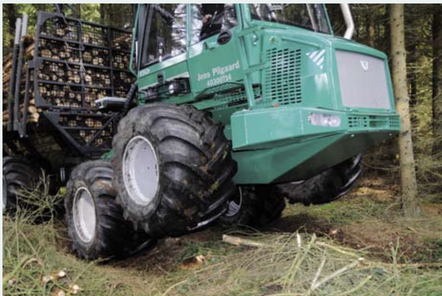
Med bogieløft kan man løfte de forreste hjul i bogierne.
