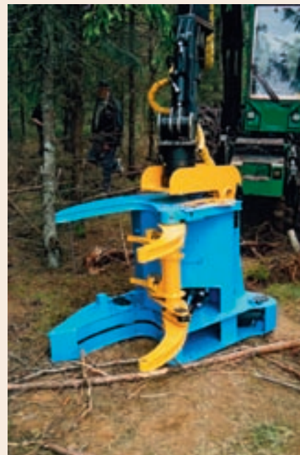
ABAB Klippen fælder træer op til 35 cm med kniv og betegnes som markedets mest effektive.
