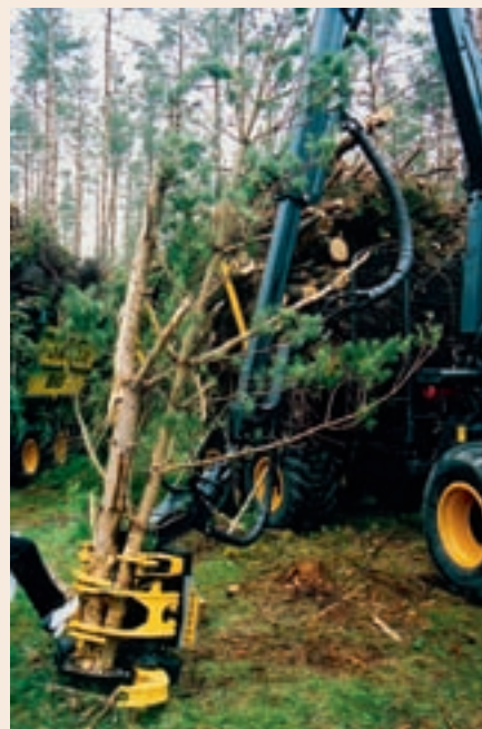
EH25 fra Ponsse som fælder og opsamler flere træer ad gangen op til 25 cm. Til H53 og H7 aggregaterne kan man få særlige kvisteknive som udover afkvistning er egnede til opsamling af flere stammer ad gangen.
