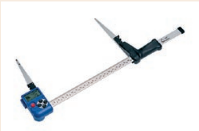
Haglöf elektronisk klup til opmåling og beregning af værdi af stående masse.
