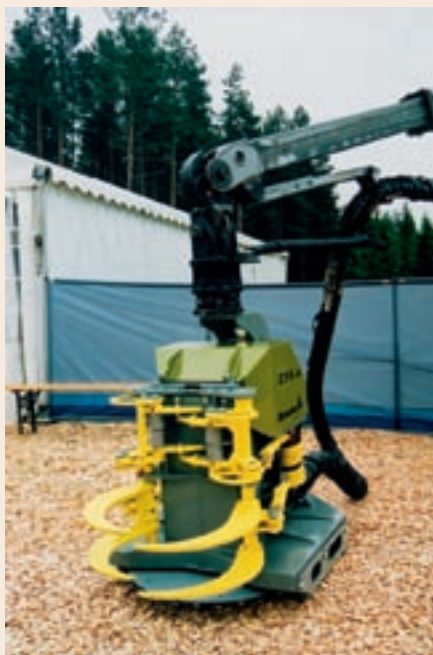
Bräcke C16.a fælder træer op til 26 cm med en motorsavskæde monteret på en stor cirkulær klinge.
