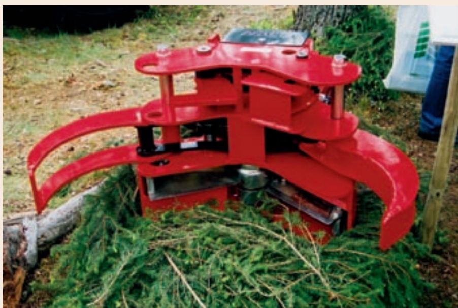
Nisula 280 E klarer træer op til 20 cm og vejer 290 kg. Den mindre Nisula 150 E klarer træer op til 15 cm og vejer kun 108 kg.
