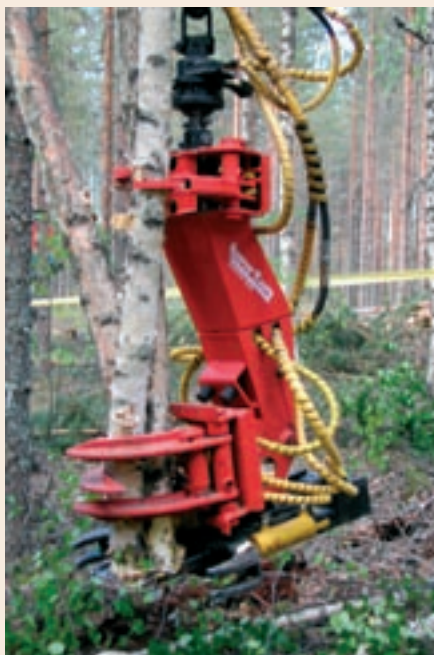
Naarva-Grip 1000-23E fælder og afkvister træer op til 23 cm. Der laves også fældehoveder der ikke kvister af.
