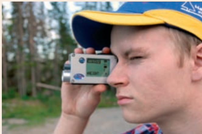
LaserAce Hypsometer måler højde, diameter og vedmasse og lagrer oplysningerne.
