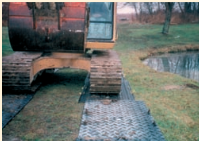
Nyt låsesystem gør det muligt at samle flere plader ad gangen.
