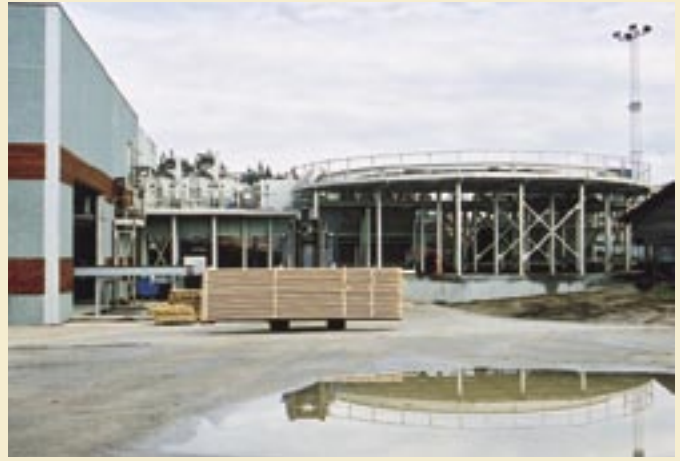
Foto 8. Gaffeltrucken henter pakken og kører den på plads. Oven over trucken ses banen hvor stammerne vendes samt afbarkningsmaskinen.
