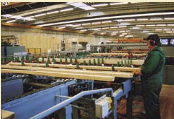
Foto 5. Planker og brædder bliver vurderet for fejl eller råd og eventuelt nedkappet i topenden.
