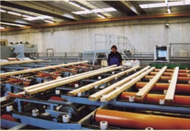
Foto 7. Når en boks i sorteringsanlægget er fyldt op tømmes den, og træet føres op i pakkeanlægget. Her stables det sorterede træ i den ønskede pakkestørrelse, og der indlægges strøer til tørringen. Der kan pakkes op til 200 emner/minut.
