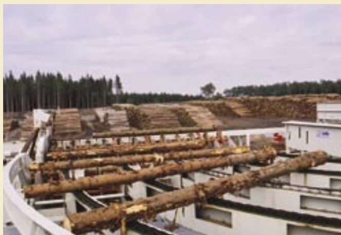
Foto 2. Stokke med for stor diameter kastes af. Stokke med rodenden forrest vendes en halv omgang så alle stokke har toppen forrest ved indtaget til afbarkeren som klarer 25 stammer i minuttet.
