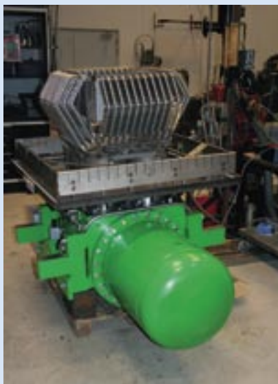
Stirling maskine der kan yde 35 kW. Den er egnet til fast biobrændsel. (Foto www.stirling.dk ).
