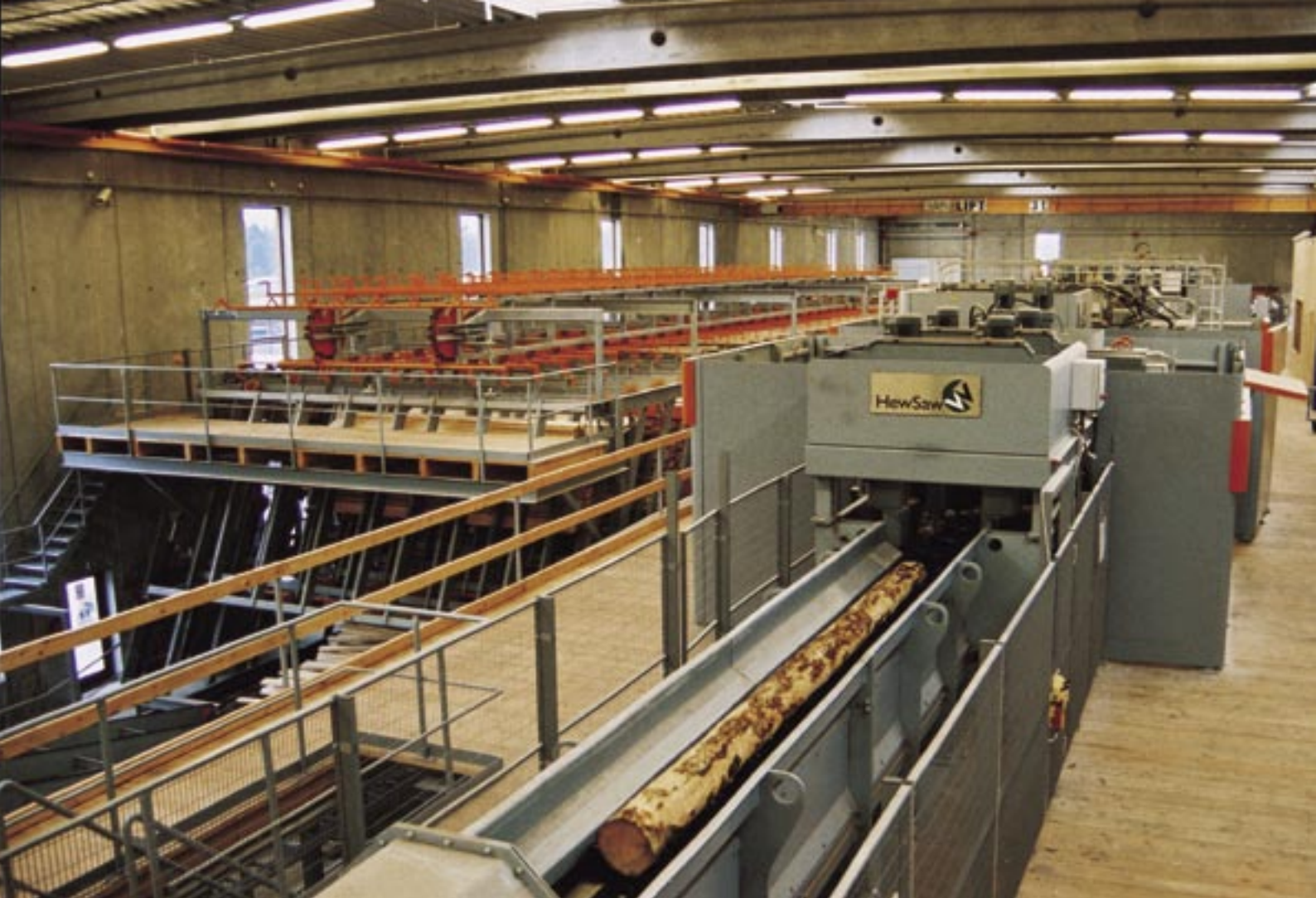
Råtræet føres ind i højre side af billedet og skæres op, det skårne træ vender for enden og kører tilbage i venstre side gennem sorteringsanlæg og pakkeanlæg.
