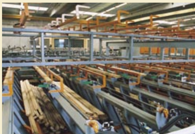
Foto 6. Planker og brædder opmåles, sorteres efter tykkelse, bredde og kvalitet og droppes i en boks. Der kan sorteres op til 140 emner/minut.
