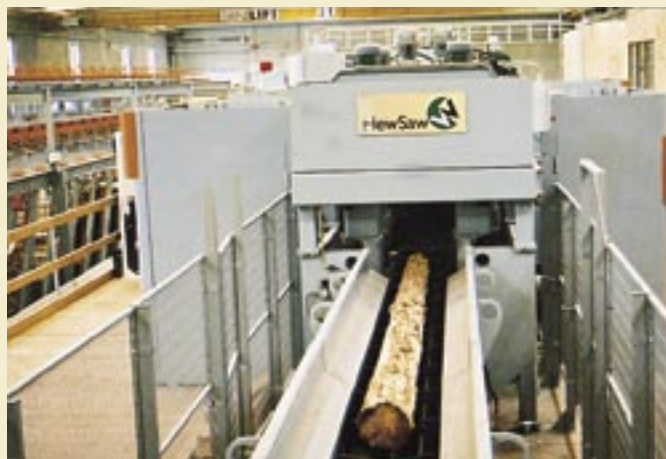
Foto 4. Stokken drejes og placeres korrekt i forhold til savene. Herefter går den ind i reducerværket og profileringsværket hvor det træ som ikke kan udnyttes hugges af og bliver til flis. De lodrette sidebrædder skæres af, stokken optimeres igen og profileres, hvorefter de vandrette sidebrædder afskæres.
