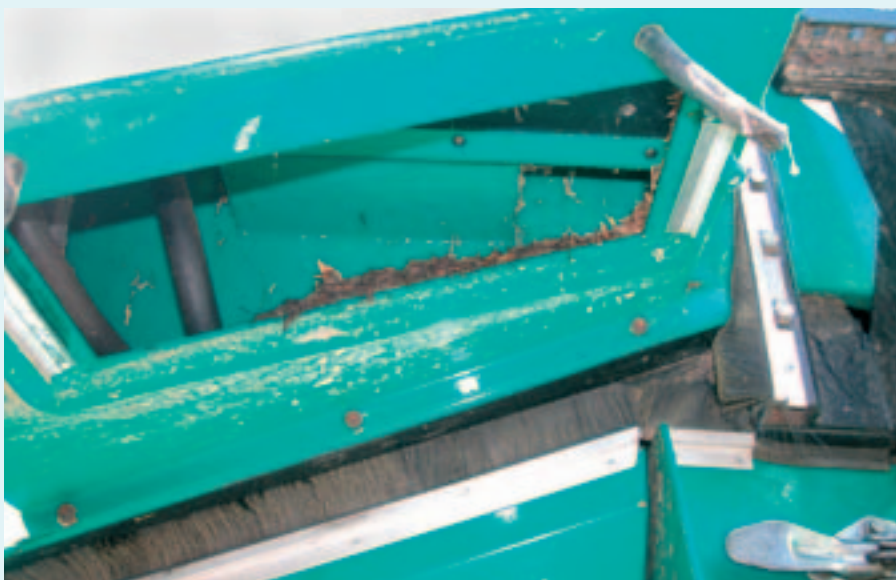
Figur 3. Filterboxen skal være tæt, så der ikke kan suges ufiltreret luft ind i systemet. Snavs på den rene side af filteret afslører utætheder. Rammen i filterboxen skal være helt lige. Hvis den ikke er det, må den rettes og forstærkes for at slutte tæt til pakningen på filteret.
