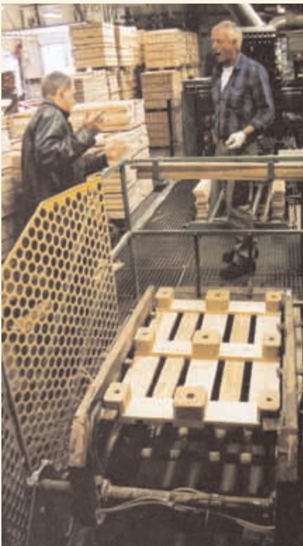
Paller produceres fuldautomatisk på maskine – man skal blot fylde brædder og afstandsklodser på i den ene ende af maskinen.
