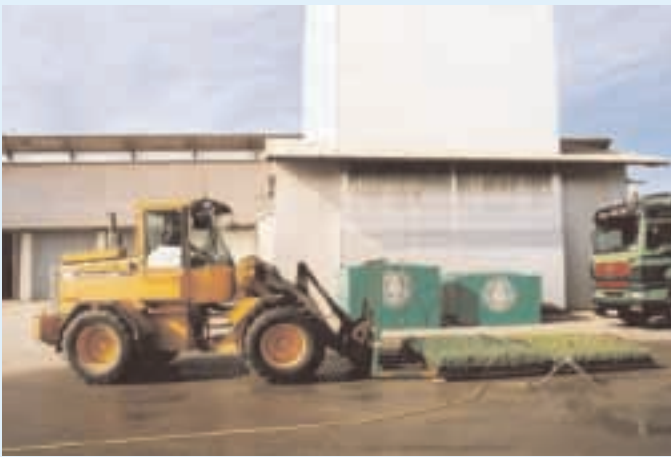
Figur 2. Planterne står i metalrammer som løftes af en gummiged. Herfra skubbes de ind på hylder i en ombygget trailer.
