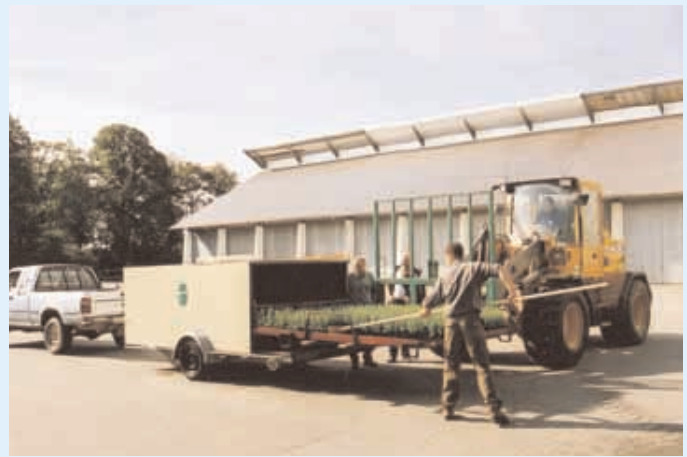
Figur 2. Planterne står i metalrammer som løftes af en gummiged. Herfra skubbes de ind på hylder i en ombygget trailer.
