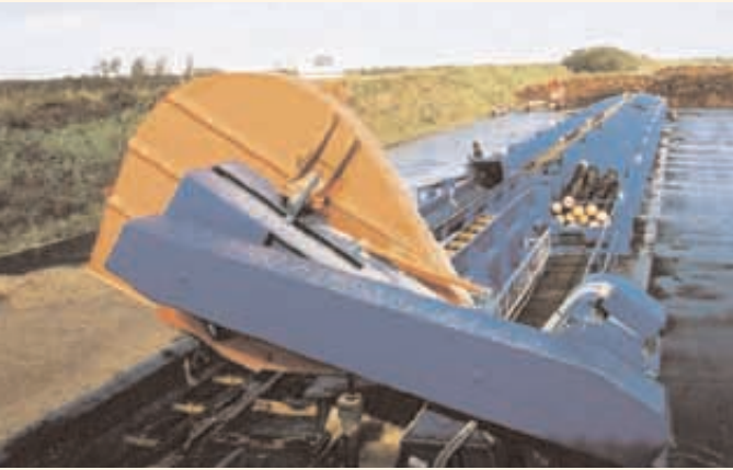
Uafkortet tømmer bliver afkortet i passende længder og sorteres ud i bokse efter længde og dimension ...
