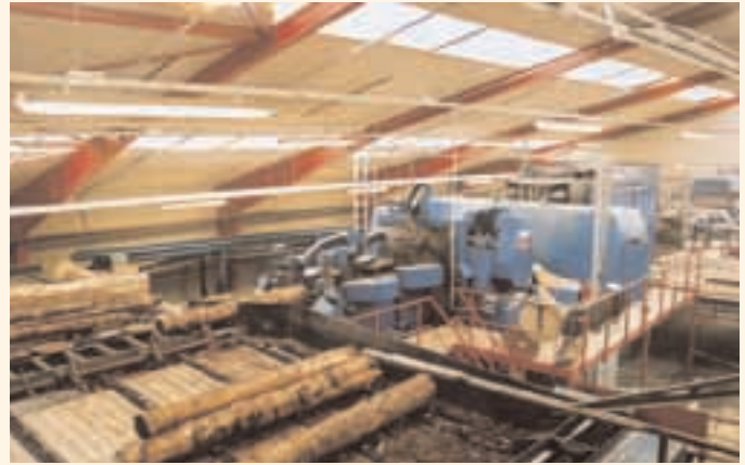
... den første maskine er et reducerværk som hugger flis af den yderste skal og skærer et bræt af hver side af stokken ...
