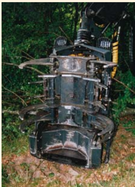
Aggregatet har en kraftig kædesav nederst samt to sæt gribere der fastholder de træer som er skåret over.
