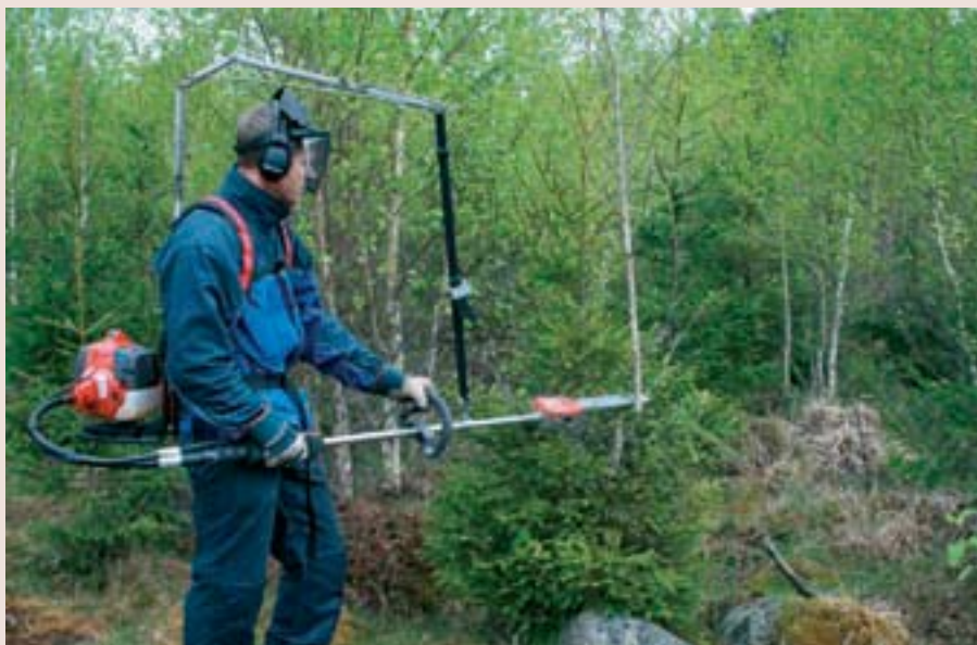
Den nye udrensningssav er egnet til udrensning i bevoksninger på 2-5 meters højde.
