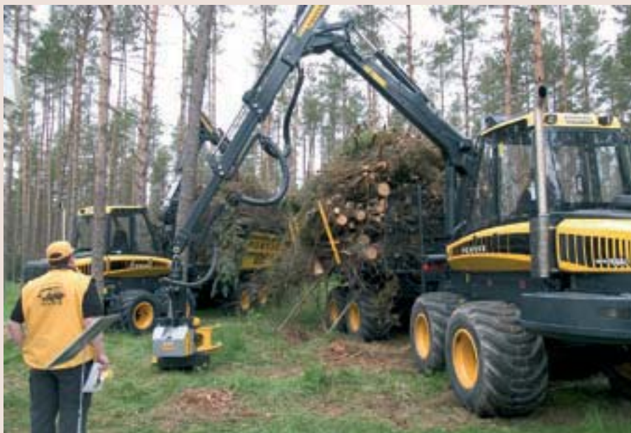
Ponsse Buffalo Dual er en kombimaskine som her har fået en vogn med komprimerende kæpstokke der presser læsset sammen. Den er derfor egnet til biomasse.
