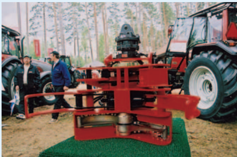
Nisula letvægtsaggregat til flere træer.
