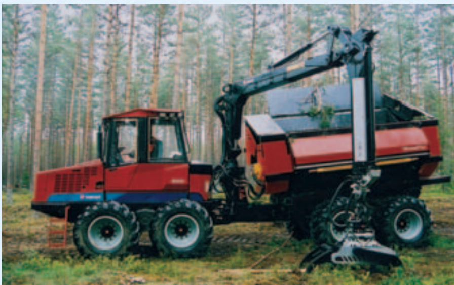
Foto 3. Valmet WoodPac bruger et andet koncept hvor grene lægges op i et presse-kammer. Den kan håndtere grene fra tyndinger.
