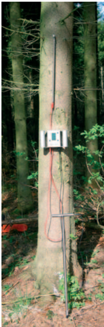
Figur 1. En råddetektor. Foto Bertil Johansson
