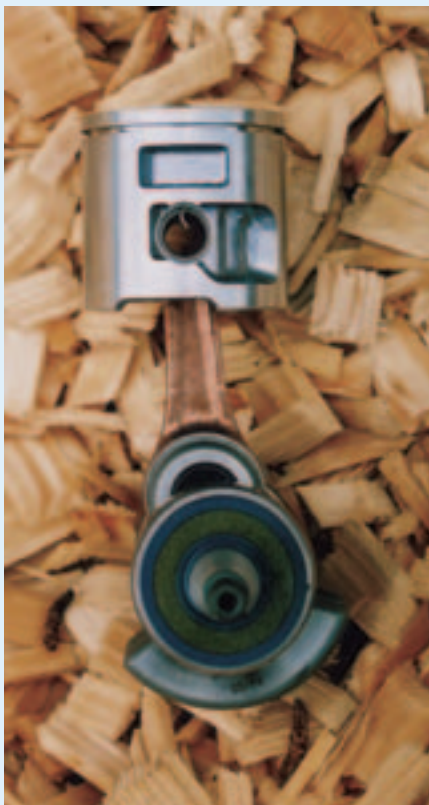
Stemplet med det hul der bruges til at tilføre frisk luft til skyllekanalen. Skitse over motorens virkemåde:
