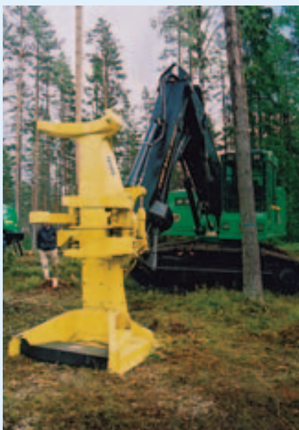
En amerikansk fælde-bunkelægger fra John Deere.
