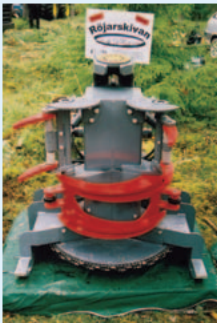
Röjarskivan Combi til udrensning af lidt større træer.
