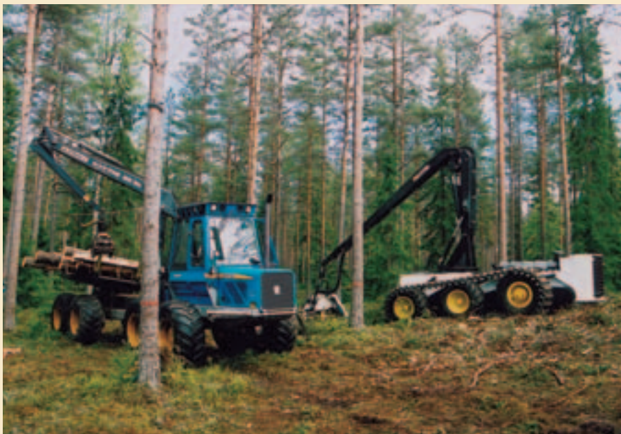
Besten er i gang med skovning, og effekterne lastes direkte i lastrummet på udkørselsmaskinen.
