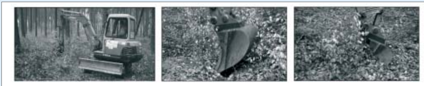
Figur 7. Anvendelse af mini-rendegraver til løsning af bøgewildlinge. Billede 1. Anbefalet mini-rendegraver på 3,8 ton, med en rækkevidde på 5 meter til opgravning. Billede 2. Skovlen bliver forsigtigt ført ind under wildlingene for at løsne dem. Billede 3. Så snart skovlen er "fyldt" trækkes den forsigtigt tilbage til udgangspunktet, således at wildlingene stadig står lodret. Herefter kan planterne forsigtigt trækkes op med håndkraft.
