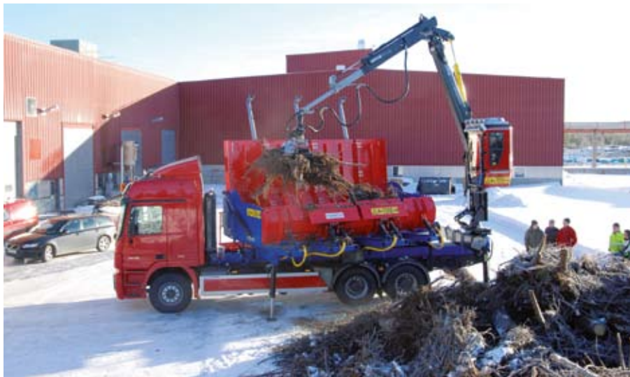
Pressemaskinen kan presse 15-20 tons grene i timen til baller.
