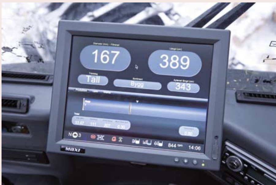
Der er udviklet en helt ny computer til aptering, MaxiXplorer, med store og tydelige tal. Der kommer snart et apteringsprogram tilpasset danske regler for tømmeropmåling.
