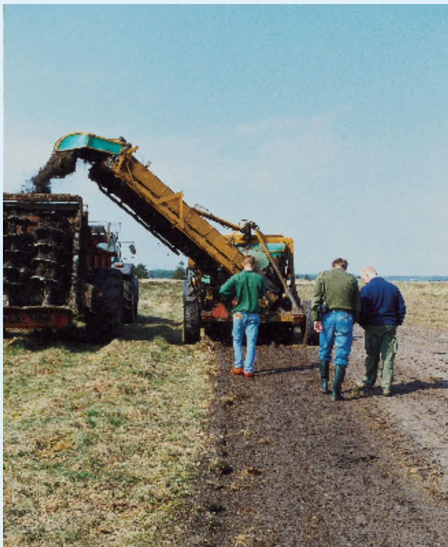
Figur 4. Den hollandske maskine afskræller lyngtørven. Det ser drastisk ud, men det er indtil videre den eneste effektive metode til at fjerne blåtoppen på.
