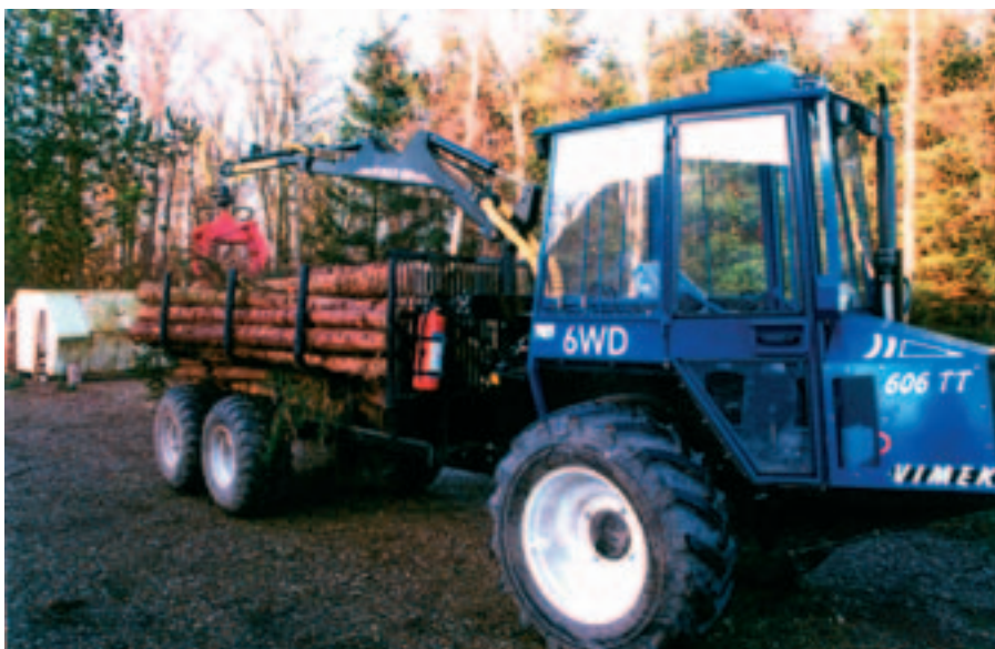
Vimek udkørselsmaskinen trækker på alle seks hjul og kommer frem i det meste terræn. Det er en lille maskine velegnet til specialopgaver.
