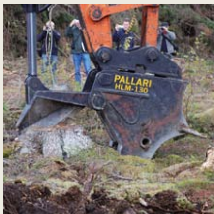
Figur 3. Stødet flækkes og løsnes.
