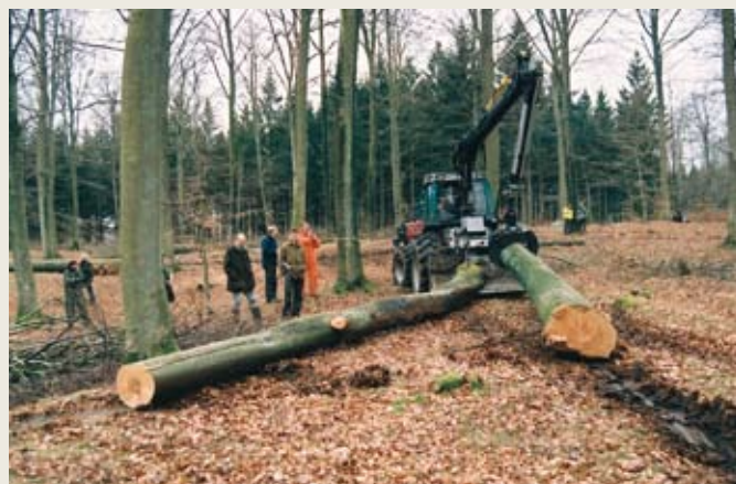
Traktoren slæber ud med 1 kævle i kranen og 1 i spillet.
