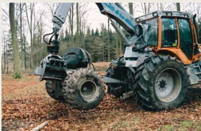
Metode 2. Traktor med kævlevogn. Traktoren bakker med kævlevognen løftet.
