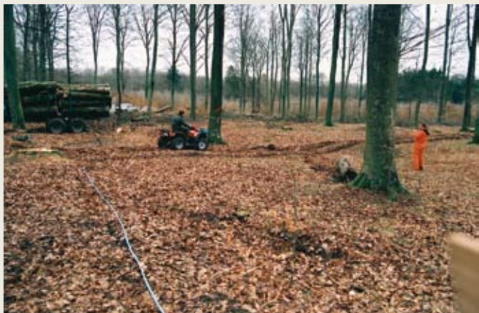
Metode 3. Spil på traktor. Wiren trækkes ud med en ATV.
