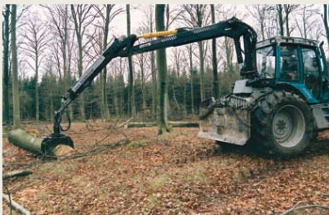
Metode 1. Traktor med kran. Kævlen trækkes ind med kranen.
