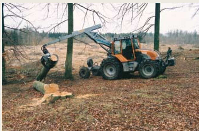
Kævler tæt på sporet nås med kranen.
