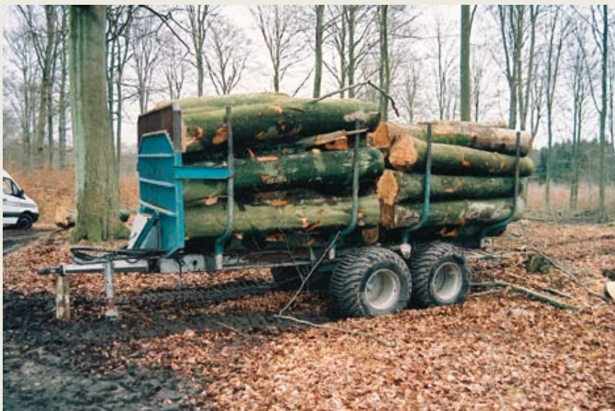
Metode 4. Kævler op til 6 m længde kan køres ud på kævlevogn.
