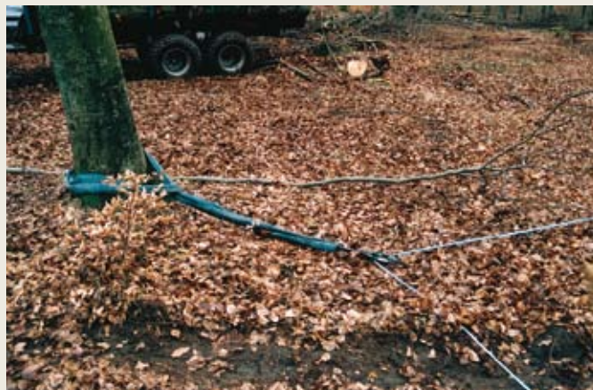
Wiren styres uden om træer med en rundsling og kasteblok.
