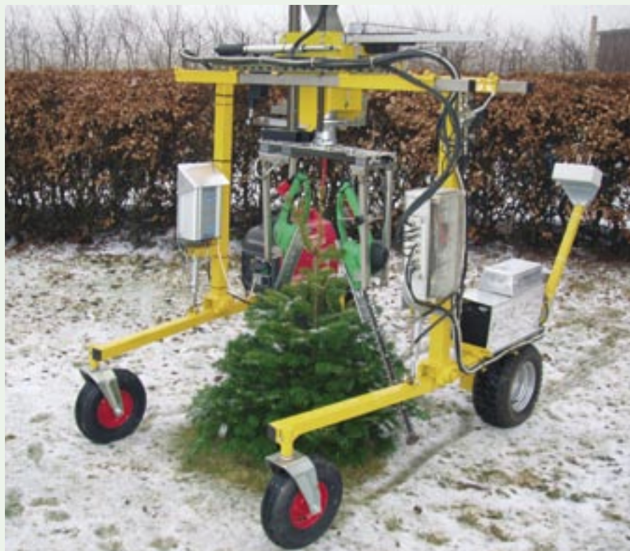
Fig. 7. Vikærslund Boogieklipper - prototype til kegleklipping af juletræer.
