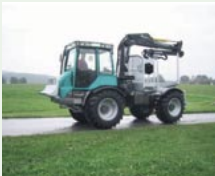
Fig. 2. Udkørselsmaskinen "FELIX" kan lave både udkørsel og udsælning.
