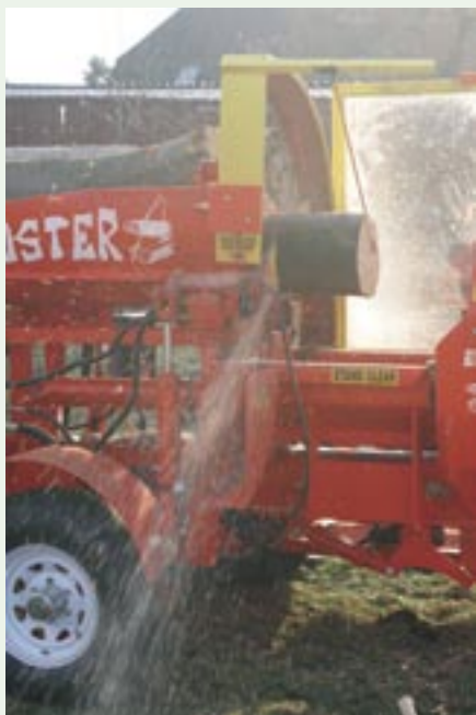
Fig. 5. Blockbuster 18-20 kan kløve stykker op til 47 cm i 8 stykker.
