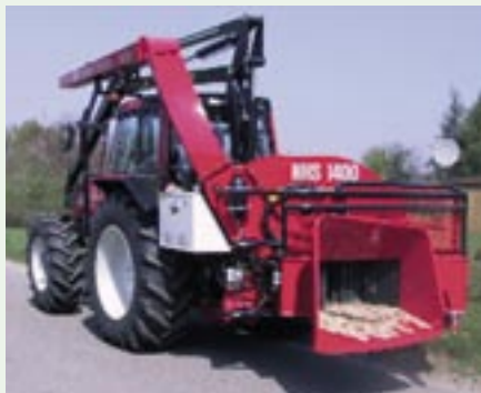
Fig.4. NHS 1400 flishugger klarer stammer på op til 45 cm i diameter.
