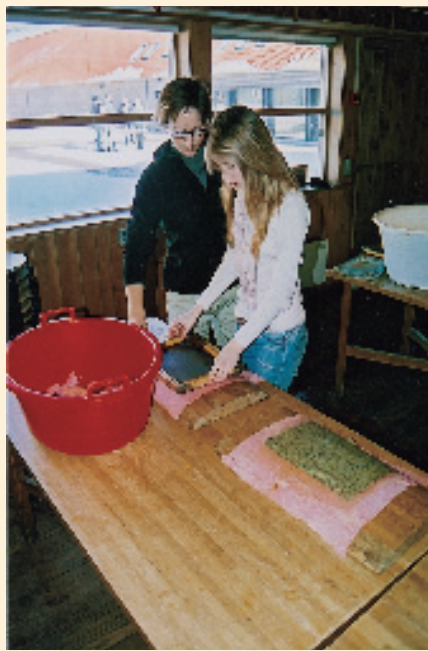
...når den er dryppet af lægges fiber-måtten ud på en klud...
