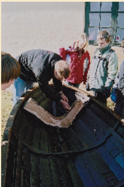
Figur 5. Sådan bruges krumtræ fra et egetræ til spanter i en båd. Foto fra Uddannelsedagen på Jagt- og Skovbrugsmuseet (side xxx).
