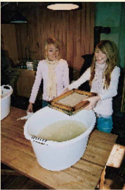
Papirproduktion: En opslæmning af træfibre lægges på et net...
