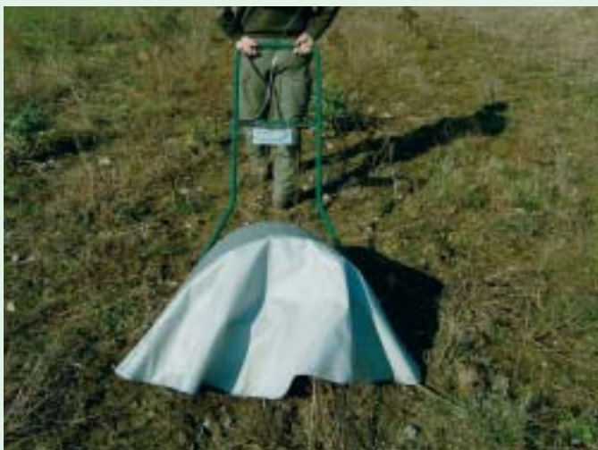
Foto 3. Flexspray i vildtremise. Den variable bredde gør at sprøjten kan stilles helt ud til planterne.
