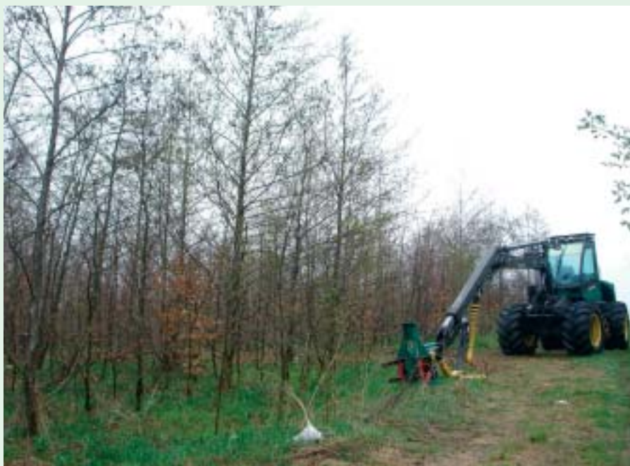
Ammetræer skoves med fældebunkelægger.
