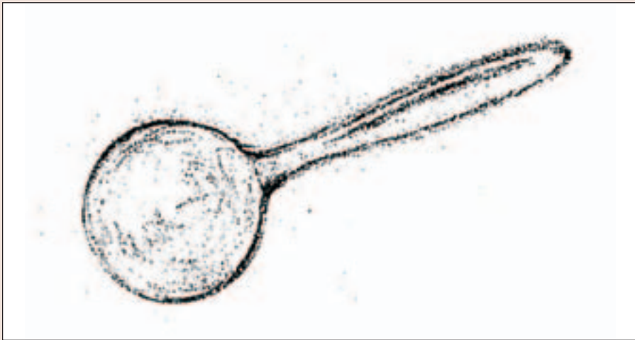
Figur 1. Skitse (efter foto af Mason) af en ispartikel, dannet ved frysning af en underafkølet dråbe. Partiklens diameter er ca. 1 mm. (Se også artikel i Vejret nr. 81 fra november 1981, side 33).
