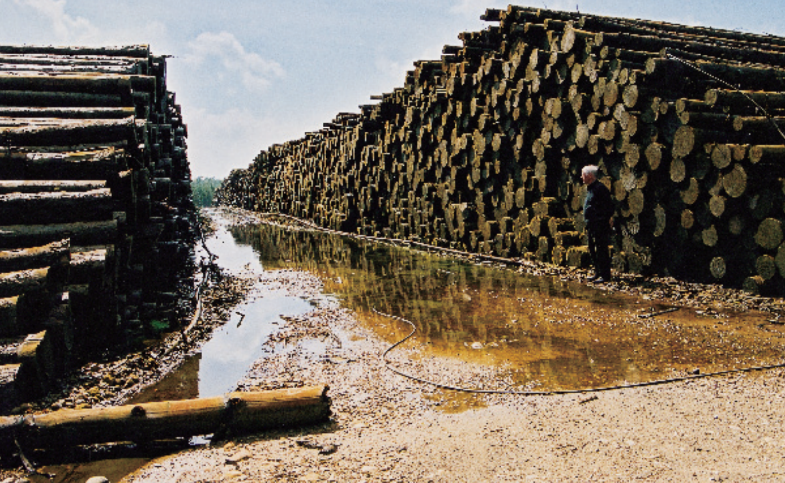
Figur 5. Savværkstømmer kan lagres i op til fem år med kun små skader. Mørkfarvningen er kun overfladisk, og ved tilstrækkelig vanding er træets tekniske egenskaber næsten ikke påvirket. (Foto af vandlageret i Hønning Plantage).
