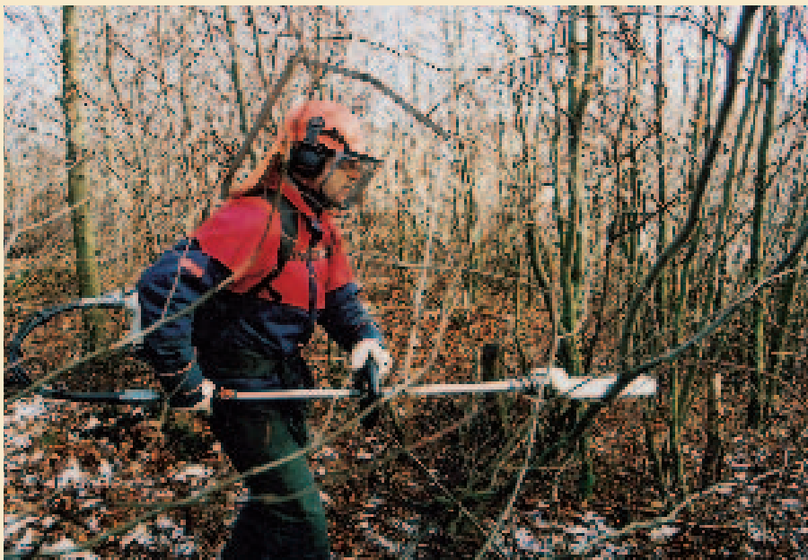
Sværdet styres ved hjælp af et håndtag midt på stangen.
