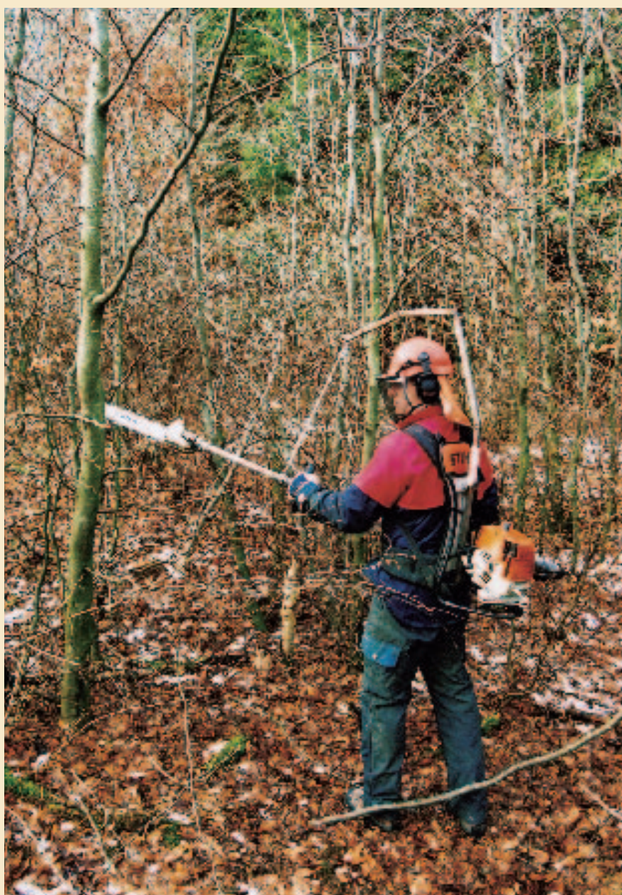
Udrensningssaven har motoren i et stativ på ryggen. Saven sidder for enden af en stang og drives mekanisk fra motoren. Stangen med saven holdes i vandret position via en stang og en elastisk snor over hovedet.
