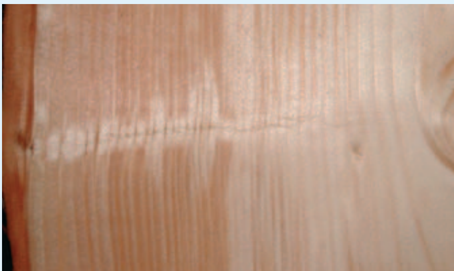
Figur 3. Planke af rødgran hvor stukninger (fiberfoldninger) ses tydeligst i det mørkere splintved med højt fugtindhold og mindre tydeligt i det lysere kerneved med lavere fugtindhold.
