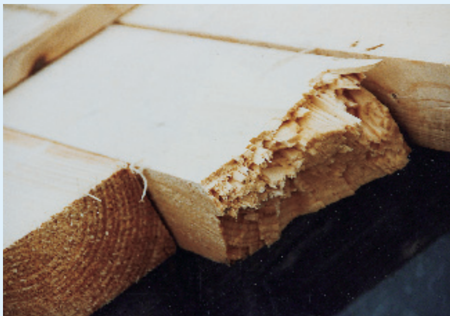
Figur 3. Stukningsbrud. Det "korte" brud vidner om indre knusninger i stammen efter storm.
