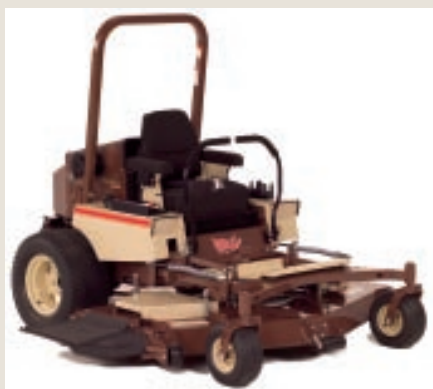
Grasshopper 322D Midmount er en "zero turn" plænetraktor med midtmonteret klipper.
