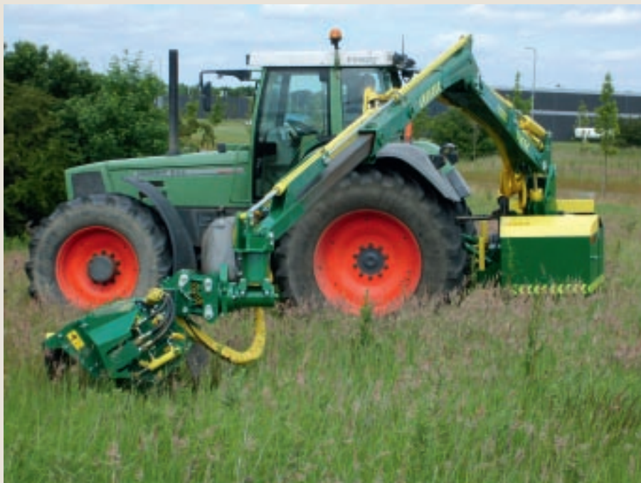
Spearhead Twiga Rotor Flex er et dobbelt drejeled der gør det muligt for slaglehovedet at arbejde i alle positioner inden for et område på 240 grader.
