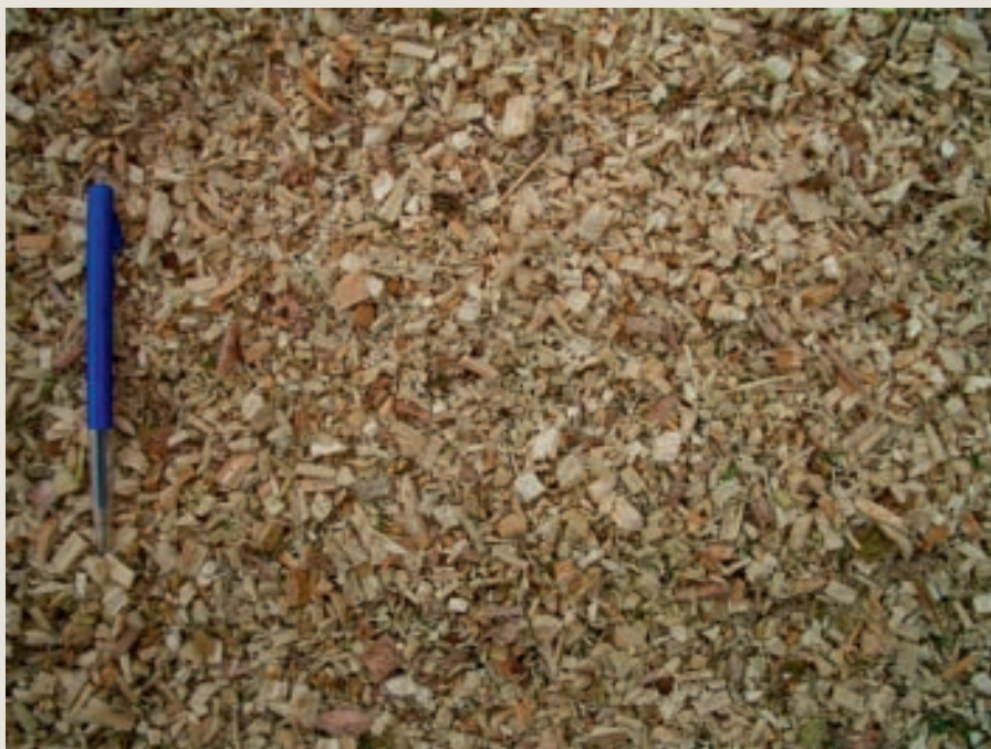
Eksempel på flis af frisk fyrretræ fra PC942-P. Knivhøjde: 13 mm. Hulstørrelse i sold: 28 mm. Omdrejninger PTO: 1.000 RPM nominelt.
