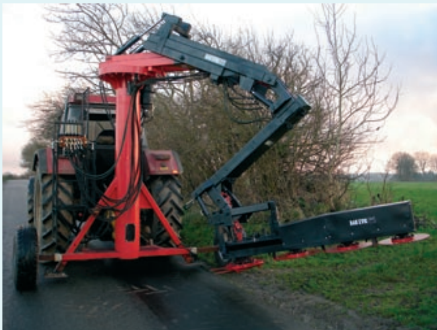
Dankvic MB 200 Multi hegnsklipper kan monteres på tårnet fra Dankvic gylleomrører.
