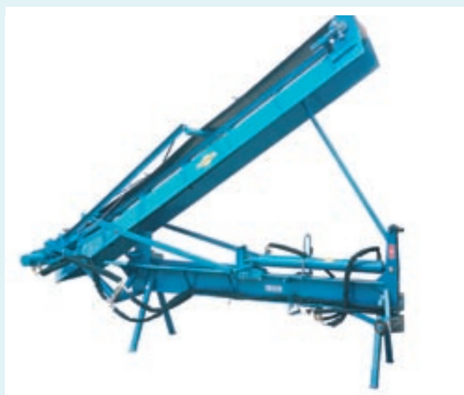
Triumf trækløver med elevator kan klappes sammen under transport.
