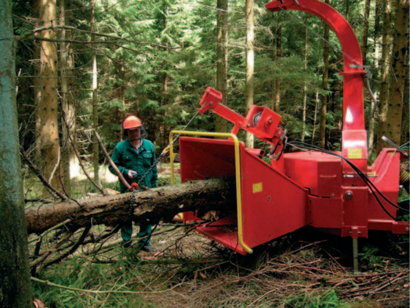
Foto 1. TP 270 flishugger er påmonteret et spil som kan trække træerne ind til tragten. Det var en tostjernet nyhed på Agromek.
