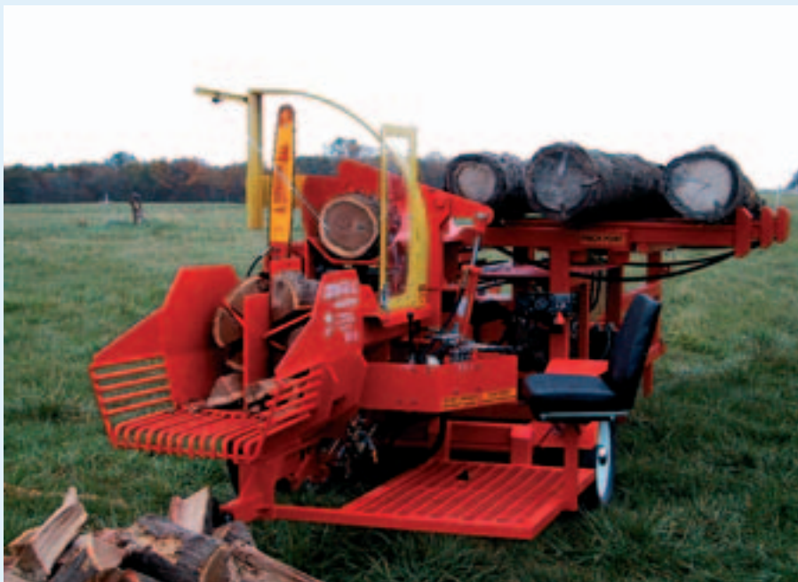
Foto 4. Blockbuster er en amerikansk brændemaskine som kan klare stammer op til 56 cm.
