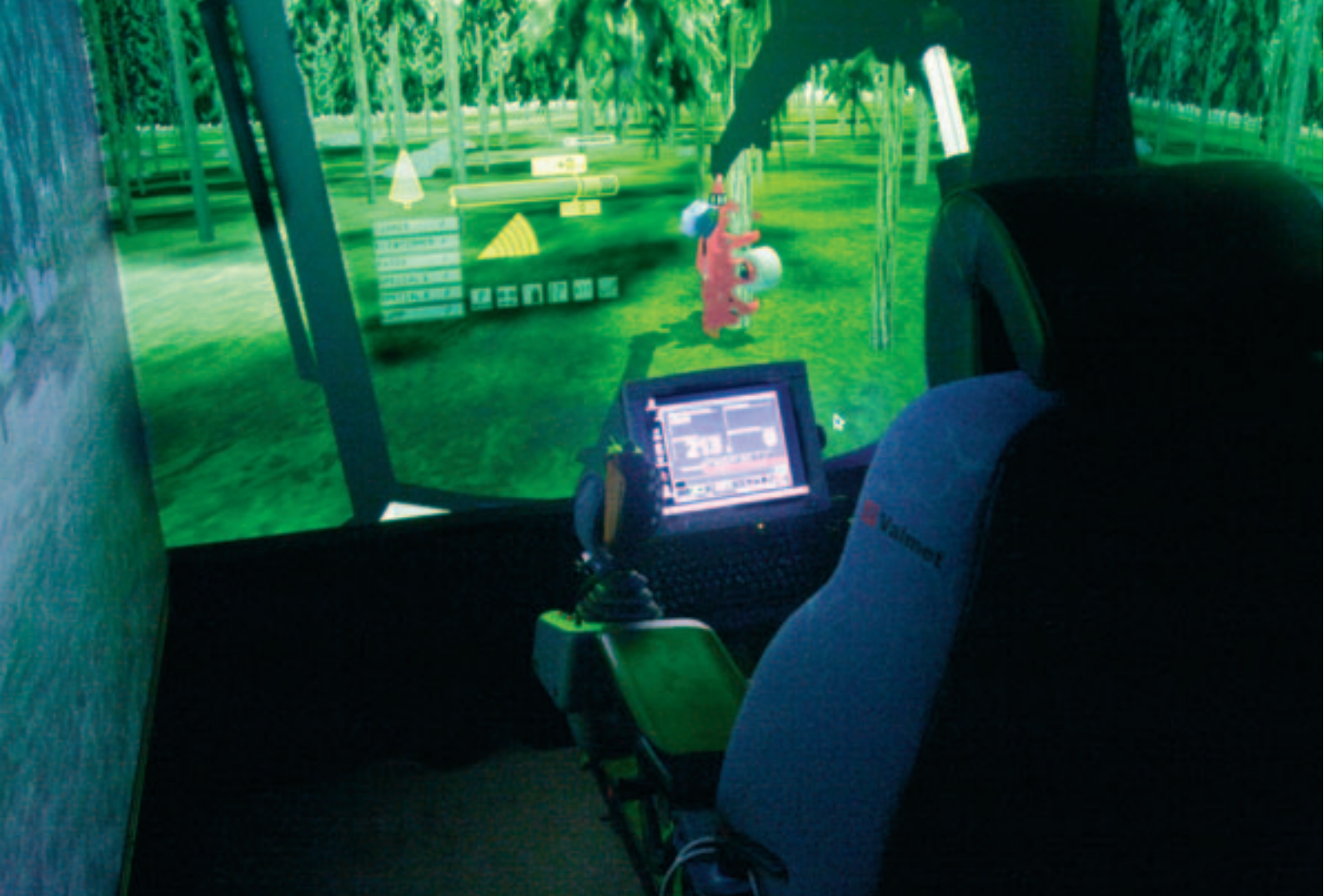
Foto 1. Skærbilledet fra apteringscomputeren kan projiceres op på forruden. Det letter førerens arbejde fordi han vil få al information fra samme sted. Her afprøves metoden i en simulator (Foto: Skogforsk).
