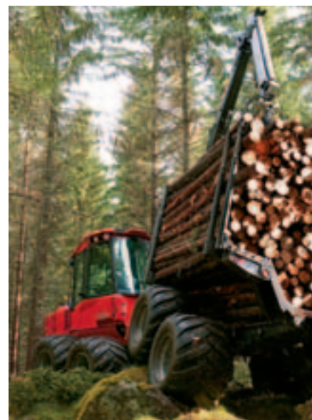
Foto 5. Det er lykkedes at lave en førerløs udkørselsmaskine som kan følge en given rute når den én gang er indkodet.
