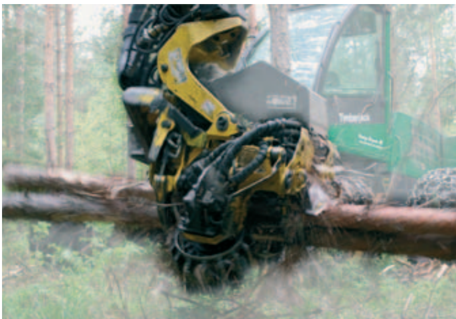
Foto 2. John Deere 745 aggregat kan forsynes med udstyr til flertræhåndtering. For nogle år siden fandtes et Timberjack 720 aggregat specielt til flertræhåndtering, men det synes ikke at være i produktion for tiden. (Foto: John Deere).
