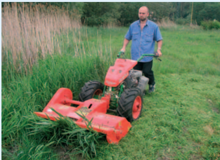
Foto 8. Agria 2500 Hydro er en tohjulet universaltraktor med hydrostatisk fremdrift.
