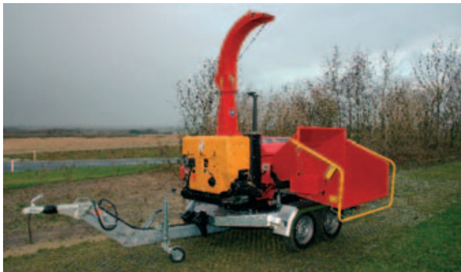
TP-flishugger, type TP 250 DHM, er videreudviklet, så den også kan monteres på en trailer, hvor den så trækkes af en påbygget 4 cylindret Hatz motor.
