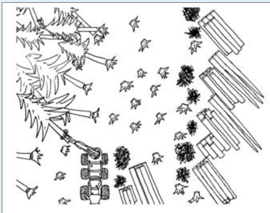
Figur 1. Skitse over oparbejdning ved træstørrelse under 0,75 m 3 . Motormanuel friskæring, oparbejdning med skovningsmaskine.
