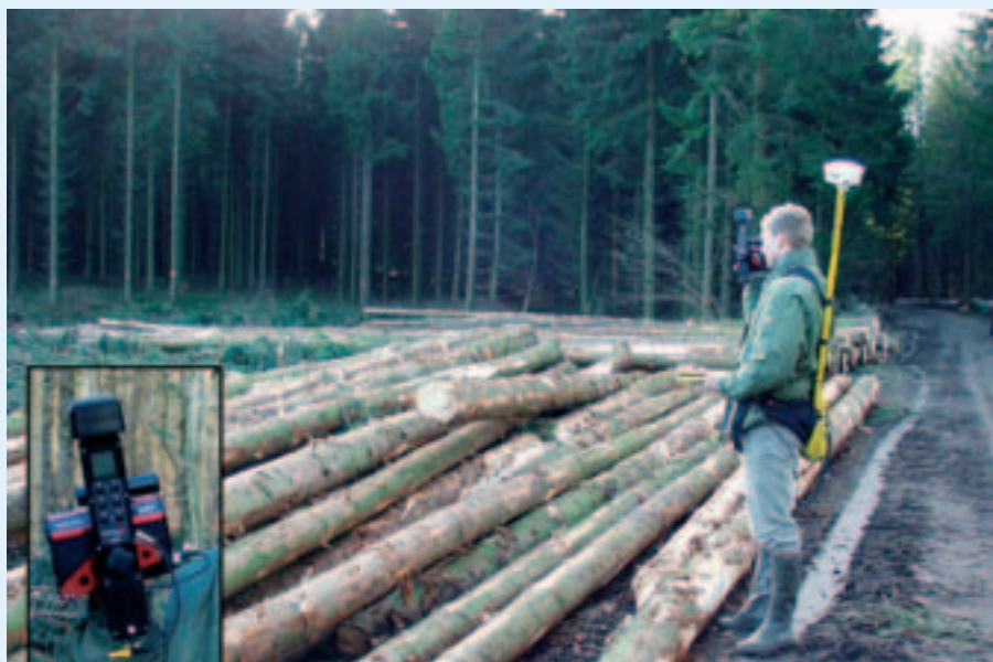
Figur 2. Ved at kombinere en GPS-modtager med en laser afstandsmåler og et elektronisk kompas, kan positioner i stormfaldskanten bestemmes.
