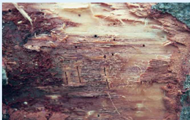
Figur 8. Borehuller fra almindelig værftbille i bøg - barken er skrabet af. (Foto: Ole Martin).
