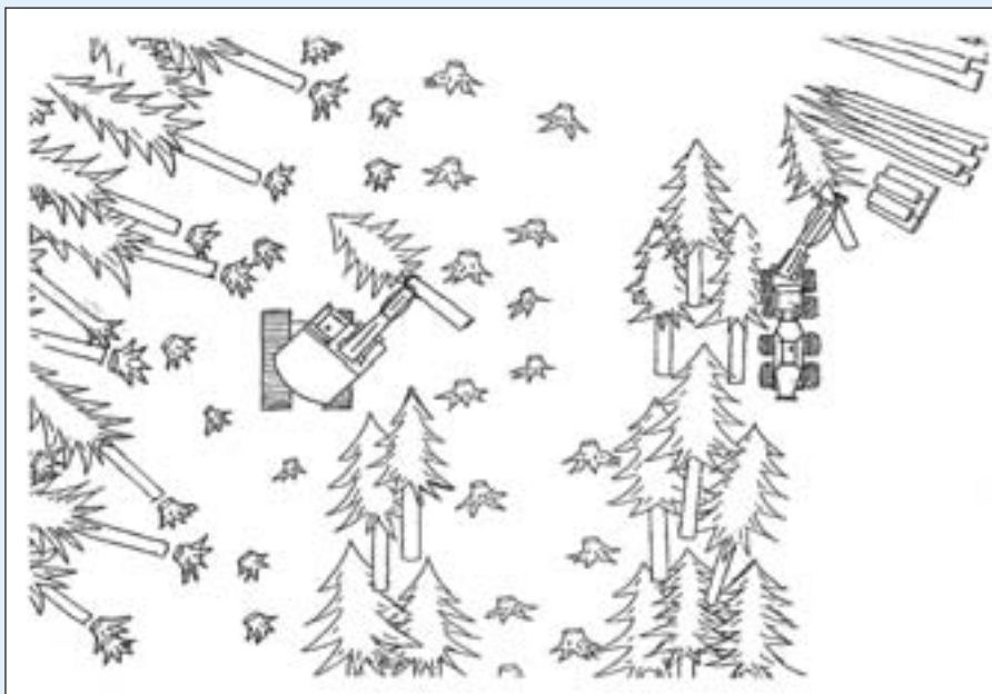
Figur 2. Skitse over oparbejdning ved træstørrelse over 0,75 m 3 . Motormanuel friskæring, fremtrækning med gravemaskine, oparbejdning med skovningsmaskine.
