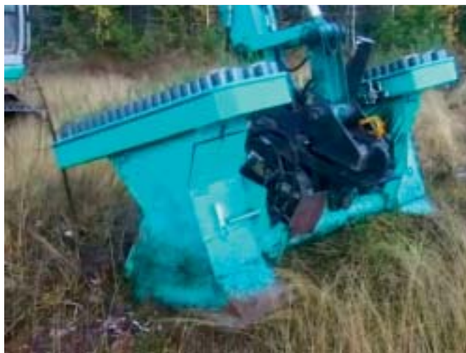
Plantemaskinen i arbejde. Den er her monteret på et bæltekøretøj. Magasinet er på oversiden, og nede ved jorden er den spade som åbner plantehullet. Foto: Metla, Det finske Skovforskningsinstitut.
