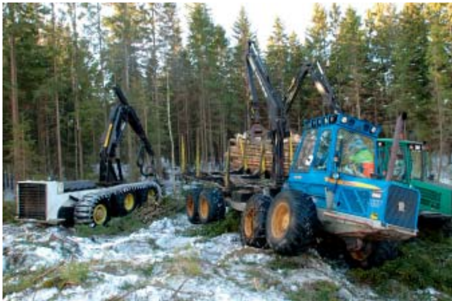
Den førerløse skovningsmaskine Besten (til venstre) viste ganske gode resultater da den blev afprøvet over for traditionelle maskiner.
