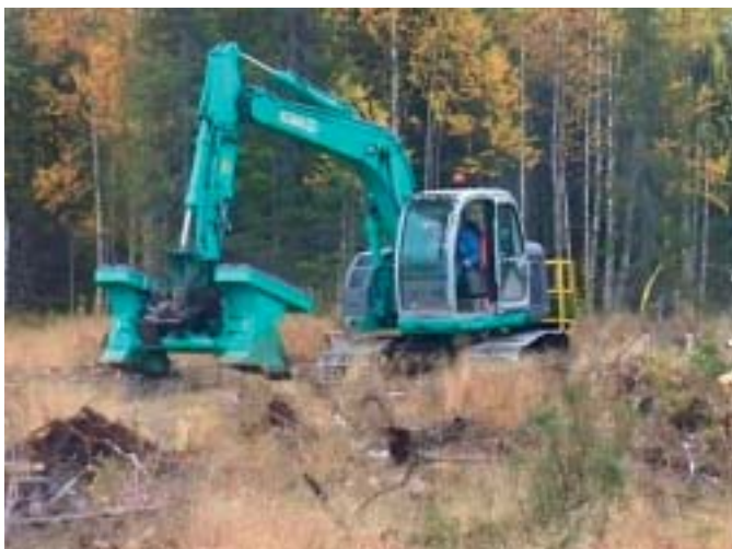
Plantemaskinen i arbejde. Den er her monteret på et bæltekøretøj. Magasinet er på oversiden, og nede ved jorden er den spade som åbner plantehullet. Foto: Metla, Det finske Skovforskningsinstitut.
