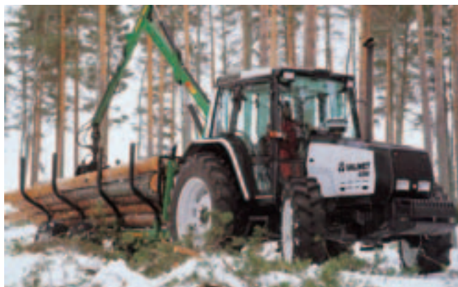
Valmet Mezzo skovtraktor – en landbrugstraktor tilpasset skovbrug fra 1991.
