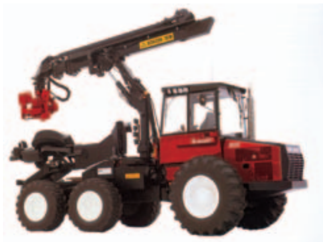
Valmet 902 fra 1989 - en togrebs-skovningsmaskine. Kranen bærer et fældehoved, og afkvistning og afkortning sker med aggregatet på maskinen. (Bagest kvisteknive, herefter madehjul, og op mod kranen findes kappesav; aggregatet drejes på tværs når det skal arbejde).
