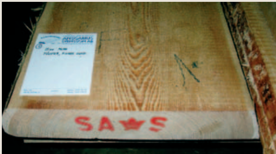
Figur 5. De bedste kvaliteter af sibirisk lærk kan bruges til fremstilling af vinduer og andre snedkerarbejder.
