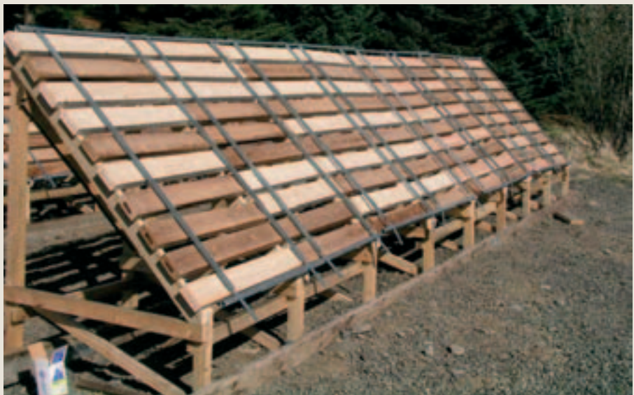
Figur 3. Farven før (herover) og efter (herunder) 4 måneders eksponering udendørs. De mørke stave har været varmebehandlede.
